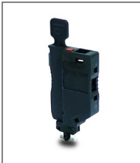
RP-FU 5x20 LED24 BK Артикул HNT-122246 Штекер-держатель предохранителя с индикацией Для клемм...-TG шириной от 5,2мм 24В / 6,3А / 5x20мм
